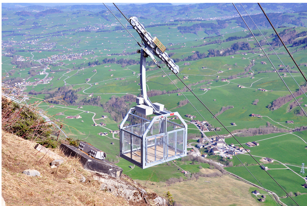
Le porte-charge sert au transport des marchandises à l'alpage Sigel.
